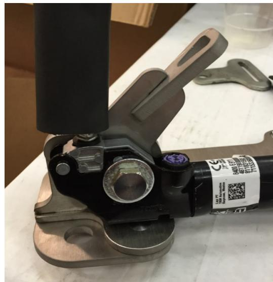
Inboard (tunnel side) seat belt mount.
